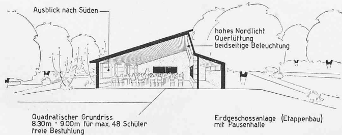
Querschnitt durch Klassenzimmer
