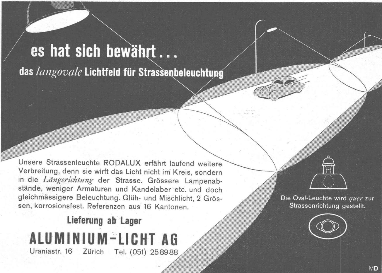
Unsere Strassenleuchte RODALUX erfährt laufend weitere Verbreitung, denn sie wirft das Licht nicht im Kreis, sondern in die *Längsrichtung* der Strasse. Grössere Lampenabstände, weniger Armaturen und Kandelaber etc. und doch gleichmässiger Beleuchtung. Glüh- und Mischlicht, 2 Grössen, korrosionsfest. Referenzen aus 16 Kantonen.
