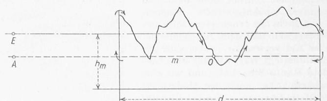
Bild 2. Planimetrieren einer durch eine Kurve begrenzten Fläche, bzw. Bestimmung der mittleren Höhe *h<sub>m</sub>* mit dem Schneidenplanimeter von P. Breitling
