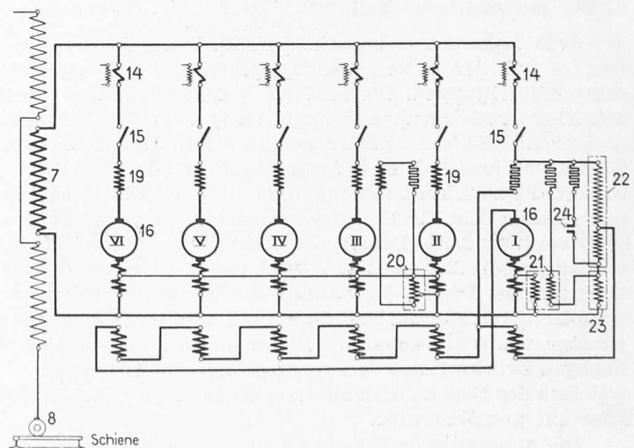
Bild 13. Prinzipschema für elektrisches Bremsen
