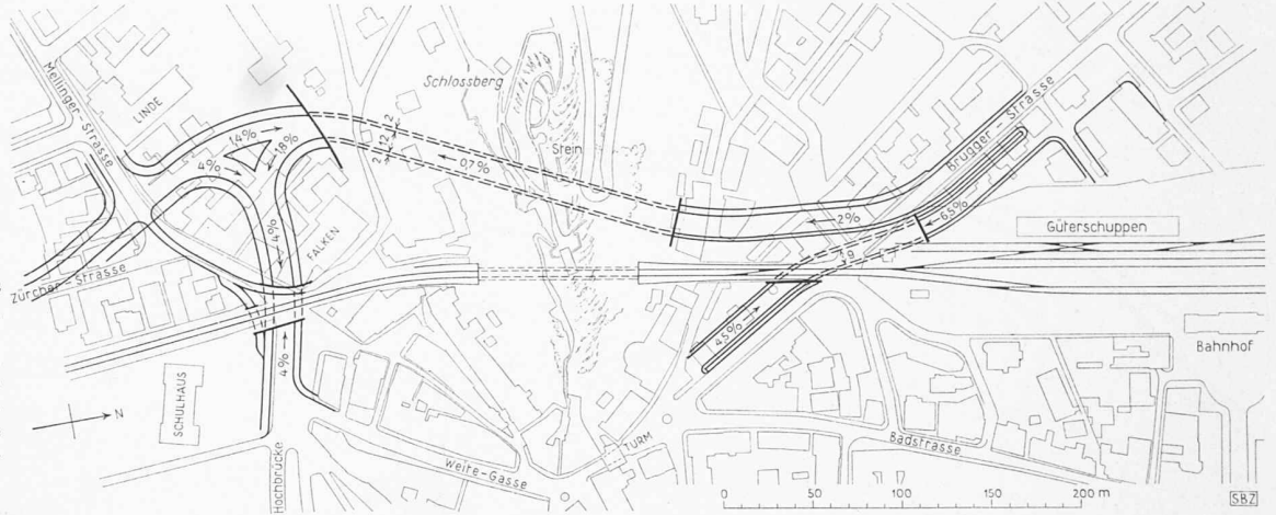
Bild 14. Vorschlag des Verfassers, März 1952. Hauptmerkmale: Strassenbreite 12 m, 9 m breite Unterführung an der Bruggerstrasse. Max. Gefälle am Knotenpunkt Mellingerstrasse 4 %
