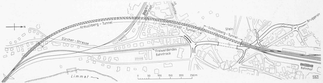
Bild 13. Vorschlag zur Bahnverlegung vom Bahnhof Baden bis zur Wettingerbrücke ohne Tieferlegung der Bahn (sog. «Kleine Bahnverlegung»). Die Hauptstrasse wird unter der Bahn durchgeführt. Masstab 1 : 8000
