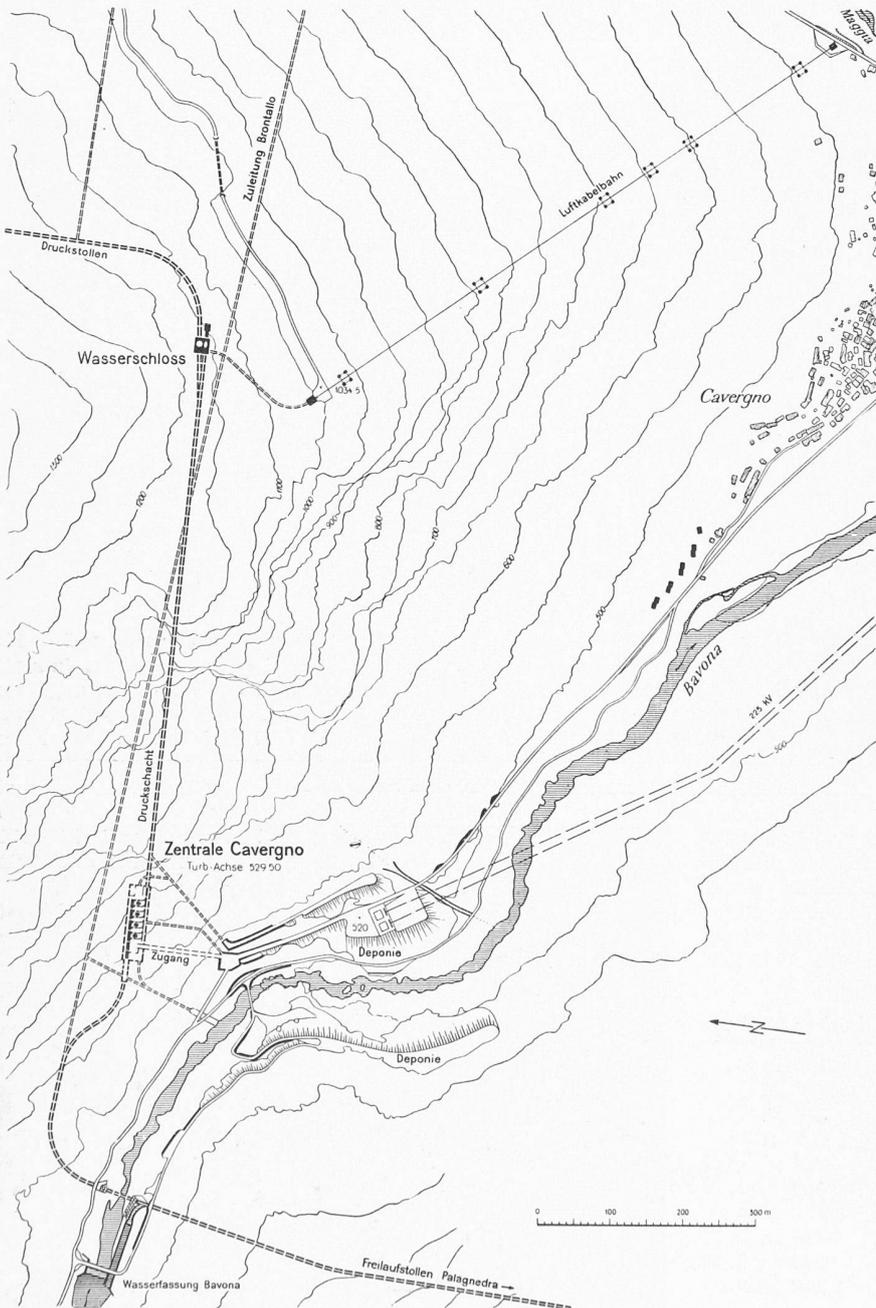
Bild 19. Wasserschloss, Druckschacht und Zentrale Caveragno, Plan 1:10 000
