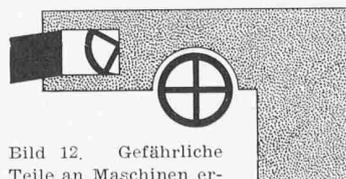
Bild 12. Gefährliche Teile an Maschinen erhalten einen orangefarbenen Anstrich
