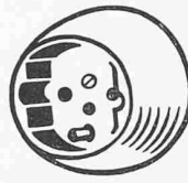
Bild 7a. Universal- oder Uebergangsmodell für Räume mit beschränkter Zulassung
