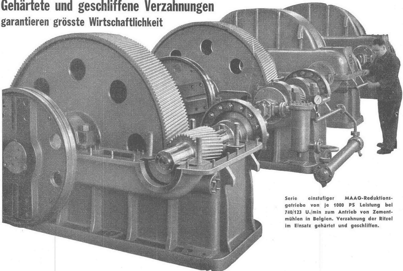
Serie einstufiger MAAG-Reduktionsgetriebe von je 1000 PS Leistung bei 740/123 U./min zum Antrieb von Zementmühlen in Belgien. Verzahnung der Ritzel im Einsatz gehärtet und geschliffen.
