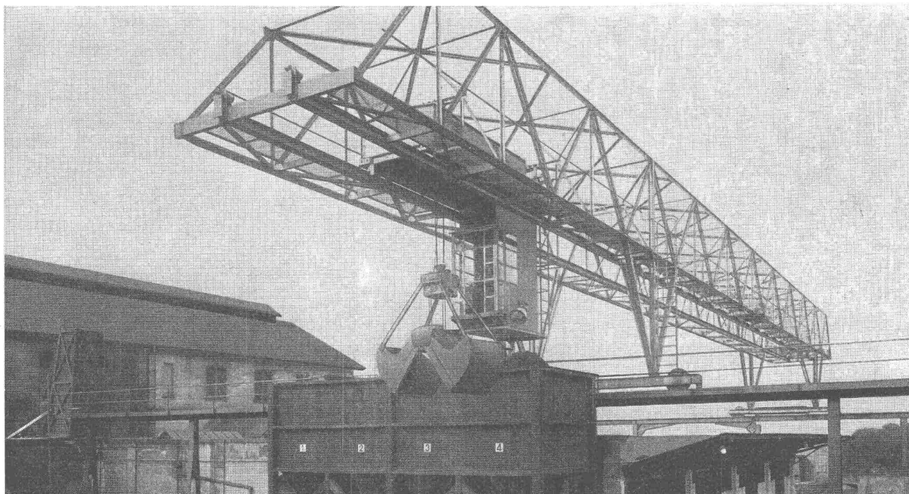
Verladebrücke in Schweisskonstruktion 2,5 t Tragkraft, 46 m Länge
