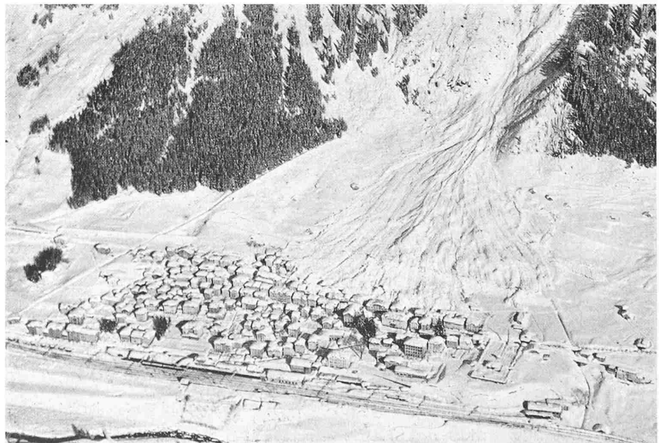
Bild 18. Aufgeteilter Bodenlawinen- kegel von Airolo, 1951. Breite rd. 400 m, Länge rd. 500 m, Höhe rd. 23 m
