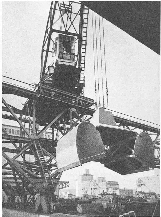
Bild 5. Detailansicht der Verladebrücke nach Bild 4, mit Getreidegreifer von 5 m 3 Inhalt (+ Patent)
