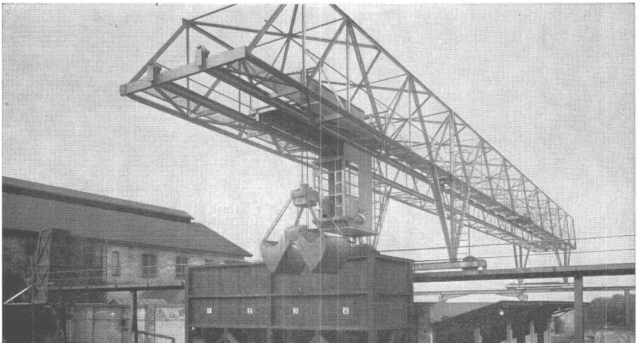
Verladebrücke in Schweisskonstruktion 2,5 t Tragkraft, 46 m Länge
