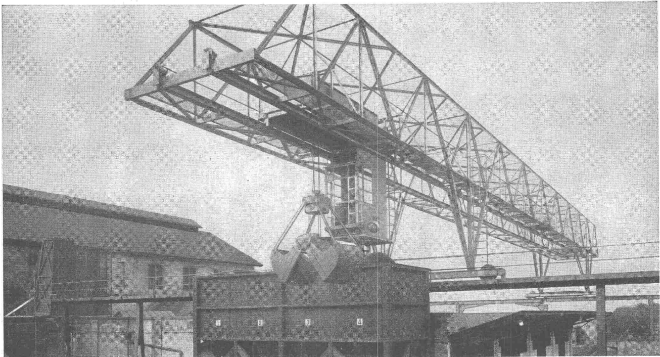
Verladebrücke in Schweisskonstruktion 2,5 t Tragkraft, 46 m Länge
