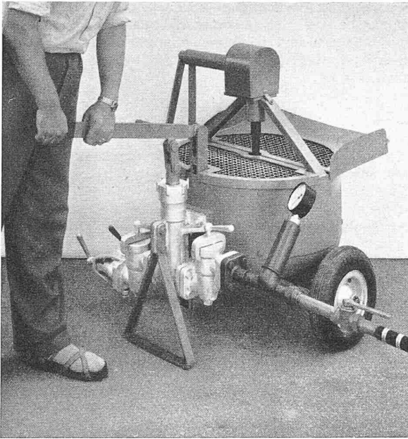
Bild 20. Misch- und Injektionsgerät BBRV für Handbetrieb
