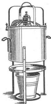
Exsicator für Neubau-Austrocknung
