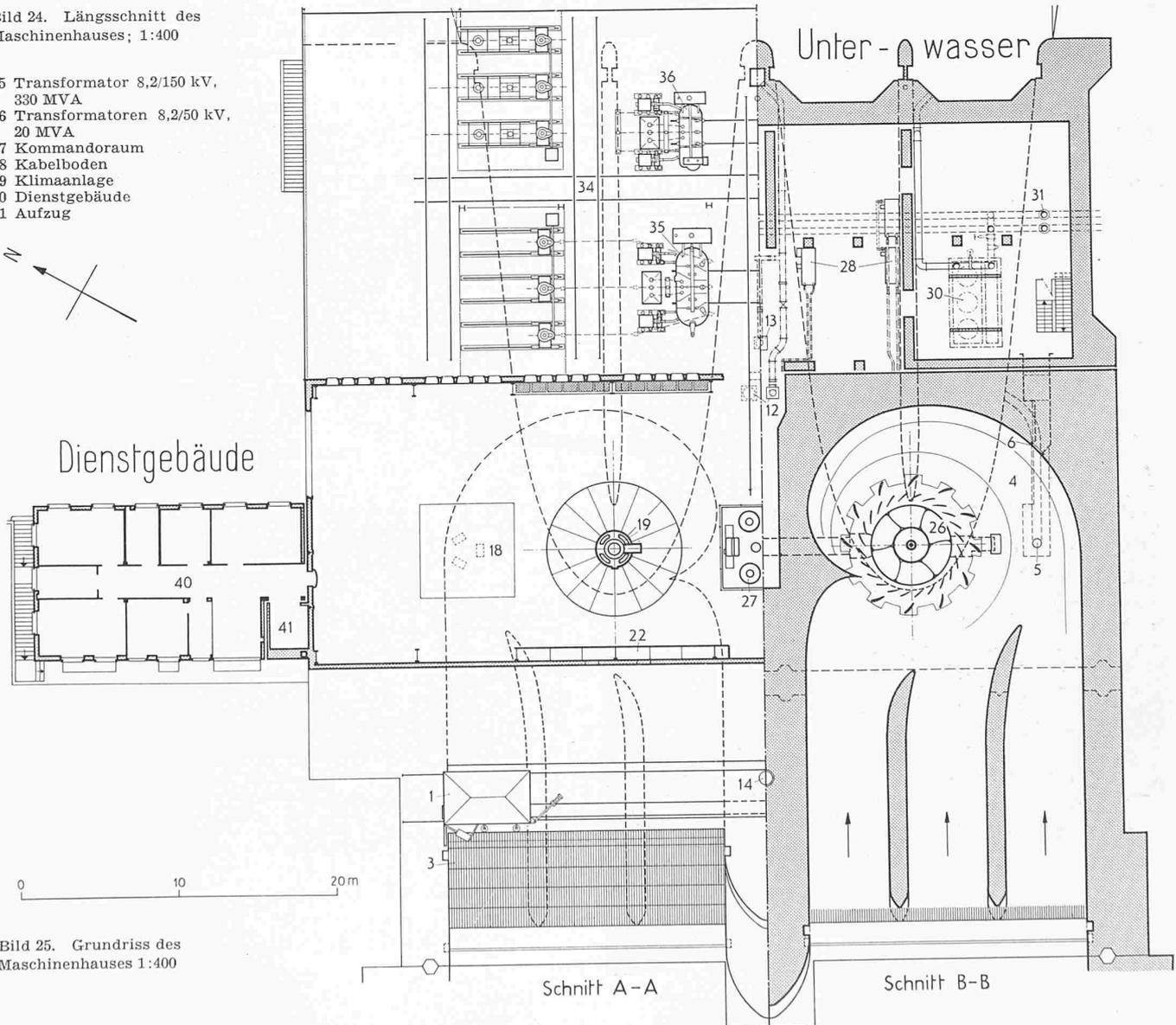
Bild 25. Grundriss des Maschinenhauses 1:400
