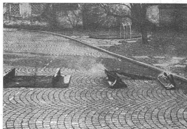
Nach 17 Minuten fiel das ungeschützte Dach zusammen — das mit «ALBI-SKK» behandelte Dach konnte nach 30 Minuten praktisch unverseht weggetragen werden.
