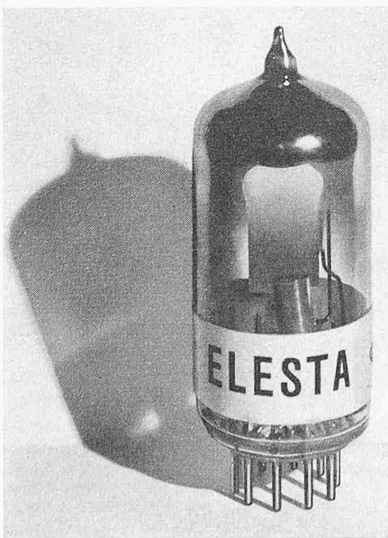
Bild 1. Kaltkathodenröhre mit deutlich sichtbarer kalter Kathode
