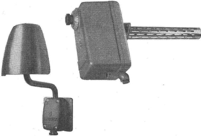
Ein neues pneumatisches PI-Relais ist für jene Fälle bestimmt, wo P-Regler zu grosse Abweichungen vom Sollwert ergeben. Es bietet den Vorteil, dass das Einstellen des Proportionalbandes am Geber selbst bewerkstelligt werden kann; die Nachstellzeit ist stufenlos einstellbar.
