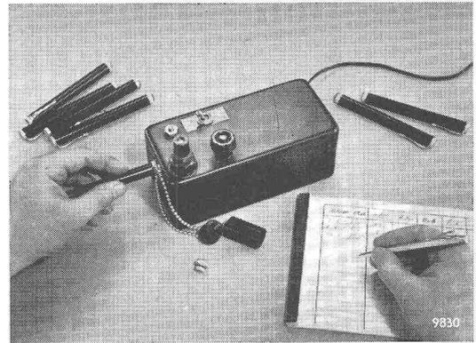
Handhabung der Dosimeterablesung. Die beiden abgeschraubten Schutzdeckel geben den Ladestützen und die Ableseskala des Elektrometers frei. Durch den Kippschalter wird das Ladeablesegerät eingeschaltet. Rechts von der Optik für die Ablesung befindet sich der Potentiometer-Drehknopf zur Einregulierung des Elektrometerfadens auf den Nullpunkt. Hinten neben dem Kippschalter der Drehknopf zum jeweiligen Einschalten der Ladespannung.
