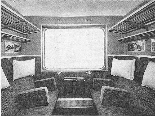
Fig. 2. Compartiment de 2<sup>me</sup> classe, avec sièges à oreillers mobiles, d'une voiture légère, à couloir latéral, des CFF. Lignes sobres et modernes, accompagnées d'un fini parfait.
