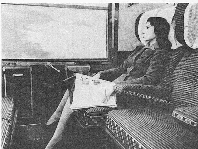
Fig. 7. Sièges de 1<sup>re</sup> classe d'une voiture moderne de la SNCF. Une forme reposante bien étudiée est la dominante de ces sièges; la parclose peut être avancée pour donner une assise plus profonde.
