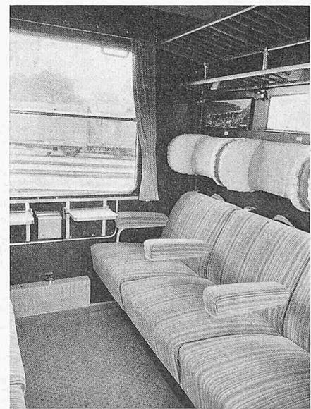
Fig. 10. Compartiment de 1<sup>re</sup> classe des voitures de 26,4 m de longueur de la DB. Les 6 sièges ont leurs dossiers légèrement inclinables; leurs parclozes peuvent être rapprochées pour former 3 places couchées.
