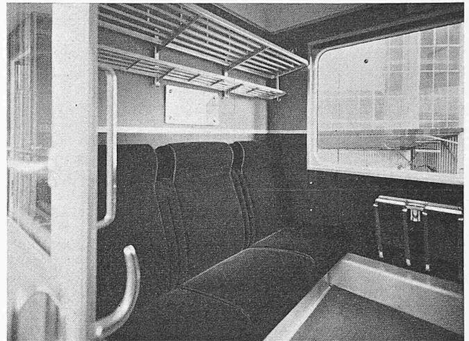
Fig. 3. Compartiment de 1<sup>re</sup> classe, avec sièges à dossier légèrement inclinable, d'une voiture allégée du BLS, destinée au trafic international.
