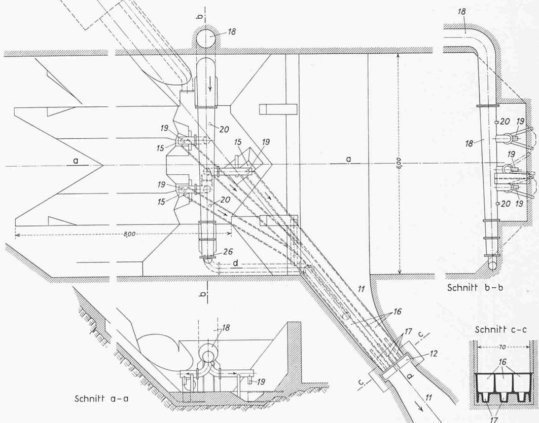
Bild 14. Triftwasserfassung; Spülvorrichtung zum Sandfang, Masstab 1:100
