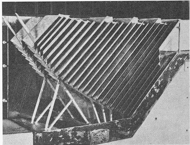
Bild 24. Versuchsmodell des Sandfangeinbaues; Wände aus Plexiglas
