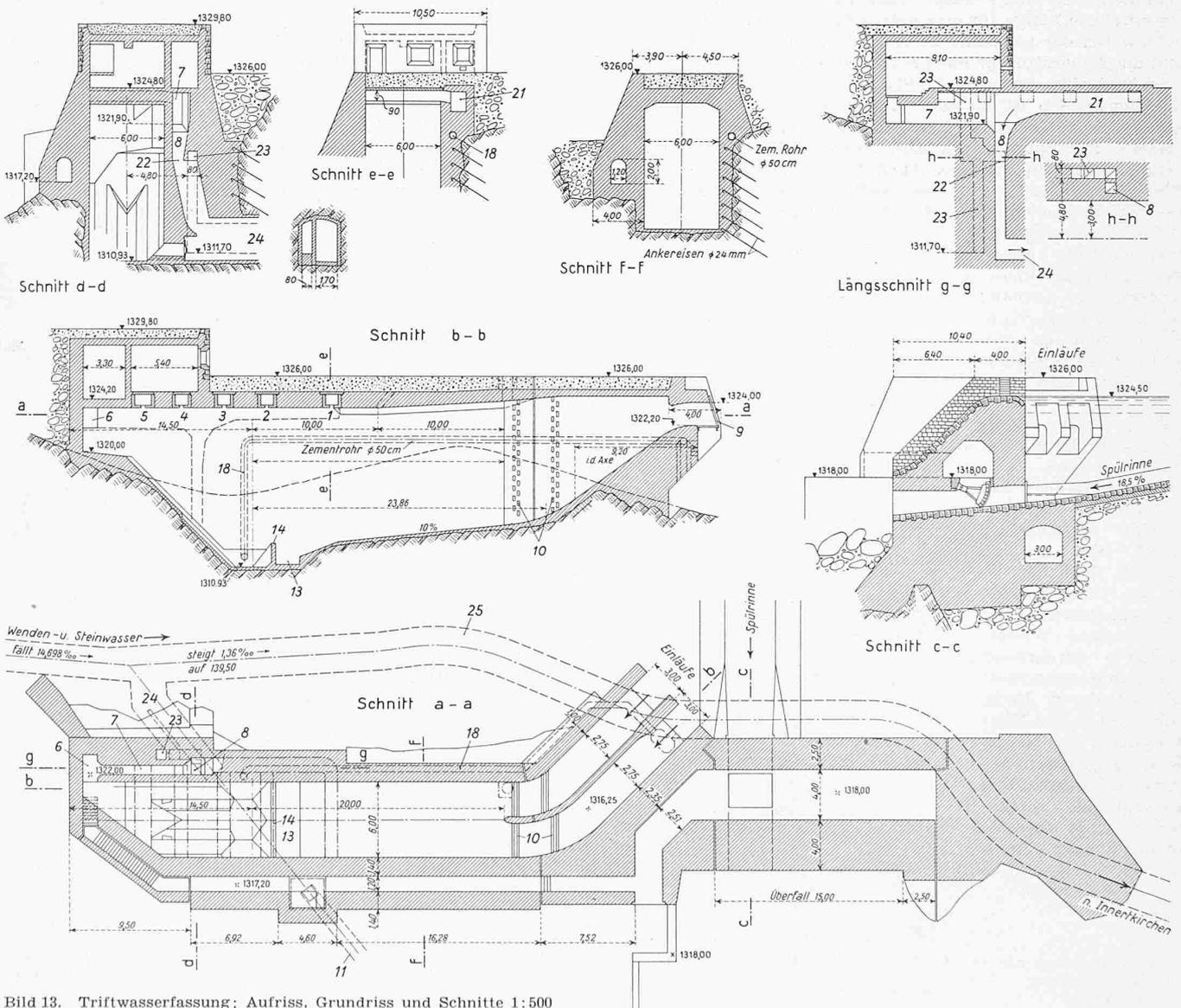
Bild 13. Triftwasserfassung; Aufriss, Grundriss und Schnitte 1:500
