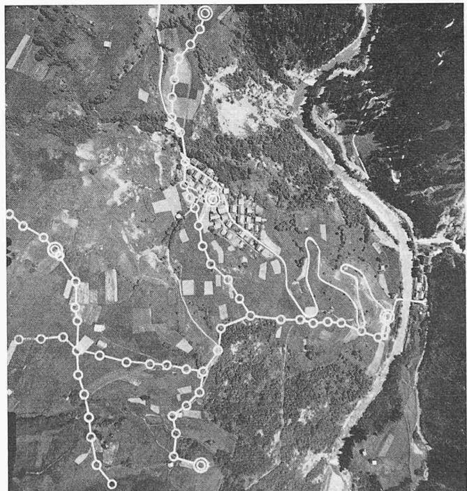
Bild 15, Verschiebungsmessungen im untern Lungnez mittels Polygonzügen. In Bildmitte Peiden, rechts Peidenbad (vgl. Bild 10)
