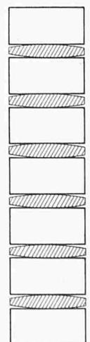
Bild 16 (rechts). Beim Austrocknen des Fugenmörtels von aussen nach innen bilden sich Spalte, die eine ähnliche, aber wesentlich schwächere Wirkung wie der Wackeleffekt auslösen
