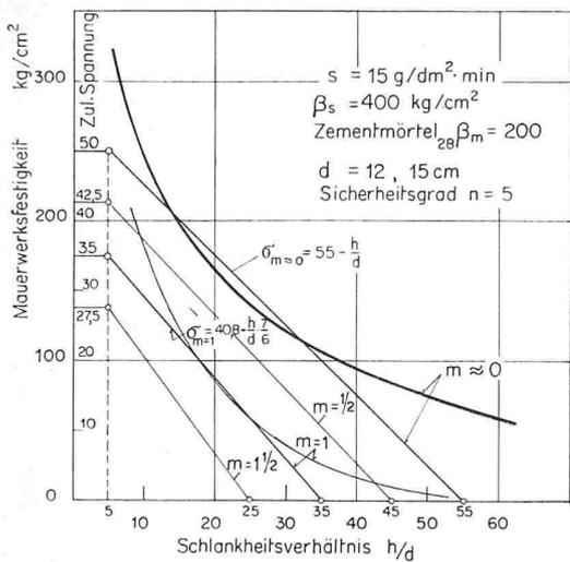
Bild 18. Mittelkurven durch die Versuchspunkte der Mauerwerke von 12 und 15 cm Dicke, hergestellt mit hochwertigen Backsteinen aus verschiedenen Ziegeleien. Steindruckfestigkeit: 400 kg/cm<sup>2</sup>, spezifische Saugfähigkeit: 15 g/dm<sup>2</sup>min, Mörteldruckfestigkeit nach 28 Tagen: 200 kg/cm<sup>2</sup>, zulässige Spannungen für verschiedene Exzentrizitäten *m* des Lastangriffspunktes  $\approx 0, \frac{1}{2}, 1$  und  $1\frac{1}{2}$  in Abhängigkeit vom Schlankheitsverhältnis
