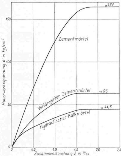
Bild 7 (links). Spannungsstauchungsdiagramme für die Mauerwerke mit den drei Mörtelarten: hydraul. Kalkmörtel HK 350, verlängerter Zementmörtel HK 250 + P 100 und Zementmörtel P 300.  $1\frac{1}{2}$  Normalsteine mit  $289 \text{ kg/cm}^2$  Steindruckfestigkeit. Zentrische Belastung, Schlankheitsverhältnis  $l/d = 20$ , Mauerstärke: 12 cm, Mauerbreite: 80 cm, Alter 29 Tage
