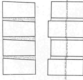
Bild 10 (rechts). Schematische Darstellung eines Mauerwerkes hergestellt mit ungleich breiten Mauersteinen. Die einseitige Bündigkeit des Mauerwerkes bringt eine örtliche Exzentrizität und Spannungskonzentrationen mit sich
