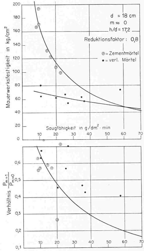
so bald die Steinsaugfähigkeit von  $7\frac{1}{2} \text{ g/dm}^2\text{min}$  auf über  $40 \text{ g/dm}^2\text{min}$  wächst. Die Mauerwerkfestigkeiten nehmen bei zentrischer Belastung erheblich ab; besonders krass ist aber die Abnahme der Tragfähigkeit mit steigendem Saugvermögen bei exzentrischem Lastangriff.
