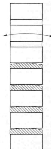
Bild 13 (links). Beim Erstellen von dünnem Mauerwerk bewegt sich der obere Teil hin und her. Ein stark saugender Mauerstein entwässert die Mörtellagen, wobei der Mörtel an Plastizität verliert und deshalb bis zu den Rändern abgewälzt wird (Wackeleffekt). Bei zentrischer Belastung treten Spannungskonzentrationen in der Mitte auf; bei exzentrischer Belastung sind erheblich grössere Ausbiegungen des Mauerwerkes und ein Abfall der Tragfähigkeit die Folge
