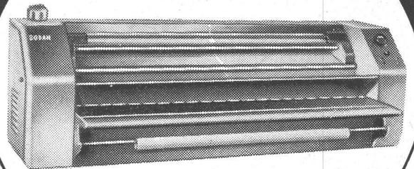
Papierdurchlass 110 cm. Leistung pro Min. 40—130 cm, max. Geschwindigkeit pro Min. 0—180 cm, Lichtquelle 4 x 65 Watt mit Reflektor, Anschluss 220 Volt, 2 Amp., Stromverbrauch 300 Watt, Länge 170 cm, Tiefe 50 cm, Höhe 54 cm, Gewicht 137 kg
