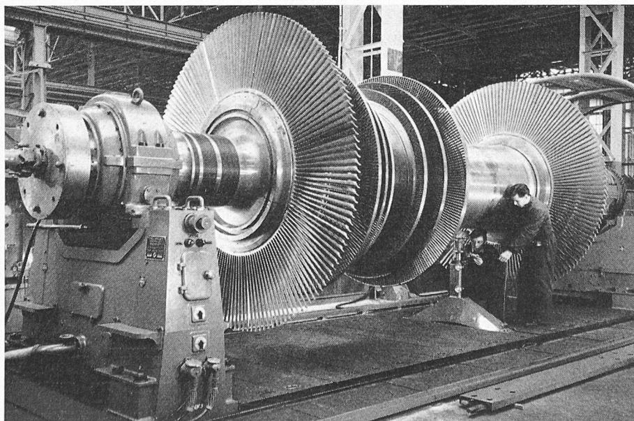
im April dieses Jahres über 40 000 h Betrieb hinter sich. Brown Boveri baute 1954 eine Vorschaltgruppe ebenfalls für 600 ° C, jedoch verwendbar für ein Maximum von 620 bis 650 ° C. Sie befindet sich bei den Bayerwerken in Leverkusen im Betrieb.
