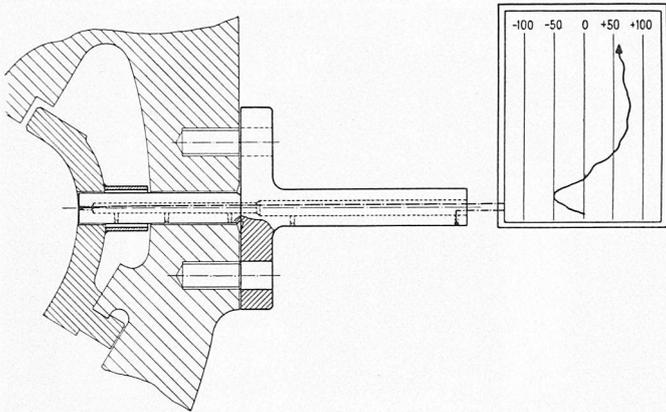
Bild 15. Temperatursonde zur Kontrolle des Belastungstempos einer Turbine
