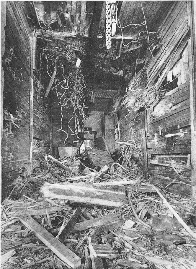
Bild 19. Folgen des Berstens eines elektrischen Turborotors in der Schleuderkammer. Die Wicklungen des Rotors kleben an allen Wänden
