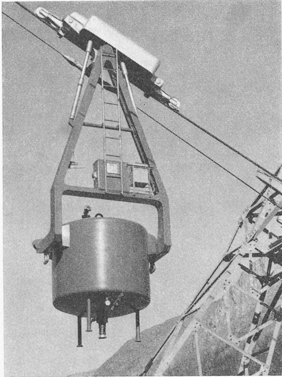
Bild 3. Fahrzeug einer 3,5-t-Materialeiseilbahn beim Zementtransport
