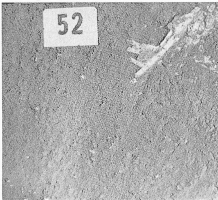
Nr. 52: Schalung ungehobeltes Holz, nicht geölt. Sehr gute Haftung des ZS
