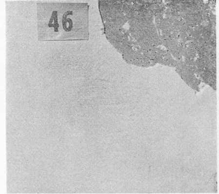
Nr. 46: Schalung mit Paste behandelte Pavatexplatte. Gips mit Plafonitzusatz haftet nur mässig bis schlecht
