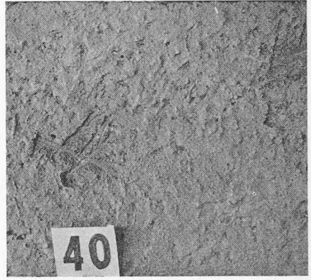
Nr. 40: Schalung aus Pavatexplatten, mit Paste behandelt. Sehr gute Haftung des ZS
