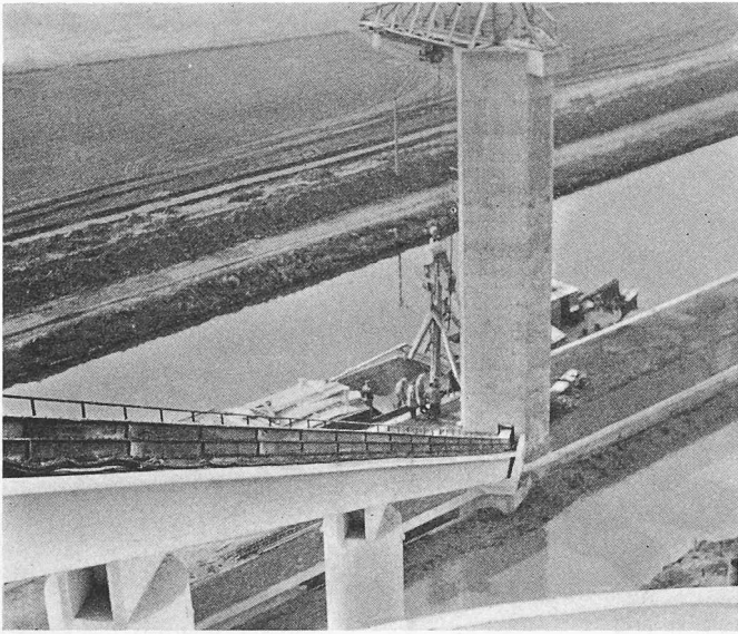
Bild 10. Entladeanlage für Kanalschiffe in Nordfrankreich. Die entladene Phosphatmenge von 100 t/h wird über einen schräg ansteigenden Kettenförderer in die Silos transportiert
