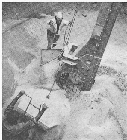
Bild 9 (links). Zuführung der Materialreste zum Aufnahmefuss des SKT-Förderers. Hierzu werden von Hand geführte Schrapferschaufeln verwendet
