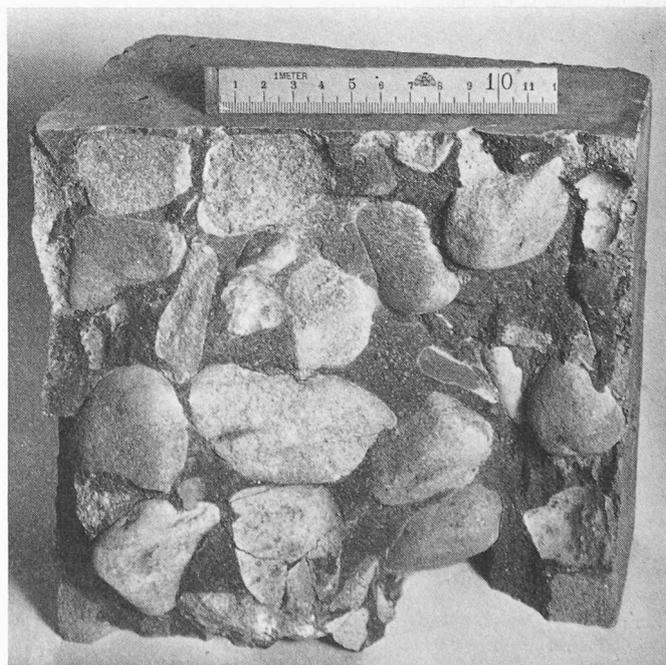
Bild 1. Colcrete-Ausgussbetonprobewürfel von 20 cm Kantenlänge nach der Prüfung auf Druck. Der Mörtel war zum Teil fester als die Grosszuschläge. Die mittlere Druckfestigkeit betrug über 500 kp/cm<sup>2</sup>
