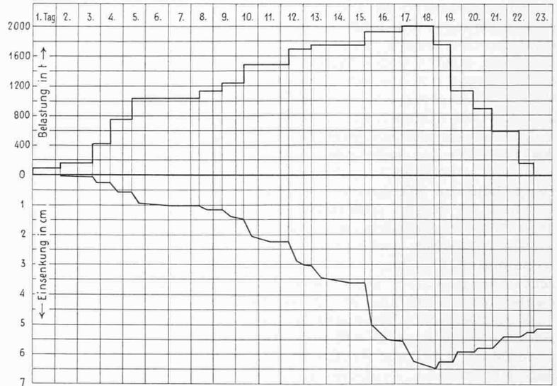
Bild 8 (rechts). Zeitsetzungsdiagramm des Probe-Bohrpfahles  $\varnothing$  1,35 m
