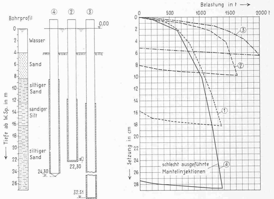
Bild 3. Bohrprofil und Länge der Bohrpfähle 4, 2 und 3 ( $\varnothing$  1,35 m), sowie Belastungs-/Setzungsdiagramme (beachte Einfluss der Mantelinjektion Pfähle 1 und 4, siehe auch Bild 4, und Einfluss der Spitzeninjektion Pfähle 2 und 3 gegenüber 1 und 4)
