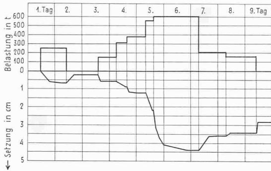
Bild 7. Zeitsetzungsdiagramm des Rammpfahles  $\varnothing$  0,915 Meter
