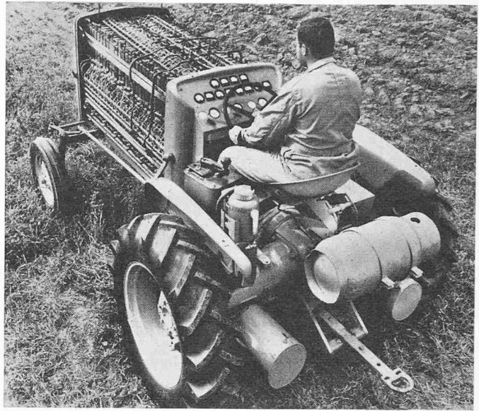
Bild 45. Allis-Chalmers Versuchstraktor. Er ist mit 1008 Brennstoffzellen ausgerüstet, die dort eingebaut sind, wo sich üblicherweise der Verbrennungsmotor befindet. Man beachte die Gaszufuhr-Leitungen und die elektrischen Anschlüsse. Es sind immer so viele Zellen in Serie geschaltet, dass sich ungefähr 60 V Gleichspannung ergibt. Der Motor von 20 PS treibt die Hinterachse an. Mit dem Controller kann die Geschwindigkeit reguliert und auf elektrische Bremsung geschaltet werden. Man bemerkt hinter dem Führersitz die Druckflasche für das Brenngas (das Propan enthält), links unten das Ende einer Sauerstoff-Flasche
