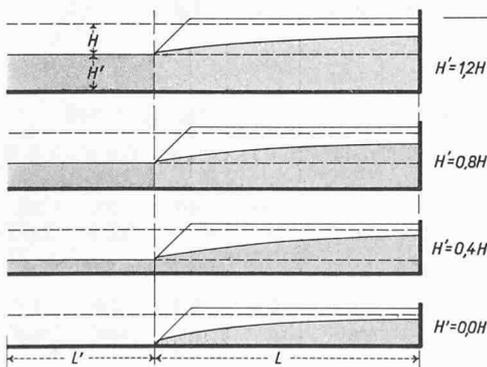
Bild 2. Untersuchte Grundwasserträger - Typen mit den Grundwasserträger-Höhen  $H' = 0,0$ ;  $0,4$ ;  $0,8$ ;  $1,2 H$  und eingetragener Sickerlinie für  $k/(n_s \cdot v) = 0,70$  und den Zeitpunkt  $32 T$ .
