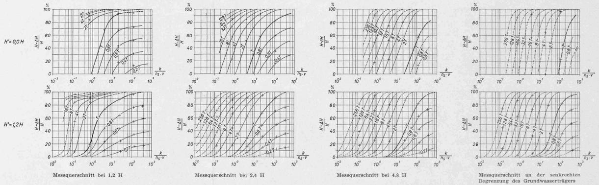
Bild 6. Füllvorgang: Darstellung der Grundwasserspiegelhöhe (Sickerlinie) für beliebige  $k/(n_s \cdot v)$ -Werte in den Messquerschnitten (siehe senkrechte Reihen):  $1.2H; 2.4H; 4.8H$  und  $8.7H$  (= Modellbegrenzung). Die berücksichtigten Grundwassertrüertiefen sind  $H' = 0.0H$  und  $H' = 1.2H$ .
