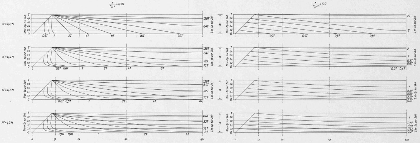
Bild 5. Füllvorgang: Sickerlinien für verschieden tiefe Grundwasserträger ( $H' = 0.0H; 0.4H; 0.8H; 1.2H$ ) mit der Zeit  $T$  als Parameter. Linke Reihe: schnelles Füllen,  $k/(n_s \cdot v) = 0.70$ . Rechte Reihe: langsames Füllen,  $k/(n_s \cdot v) = 100.0$ .
