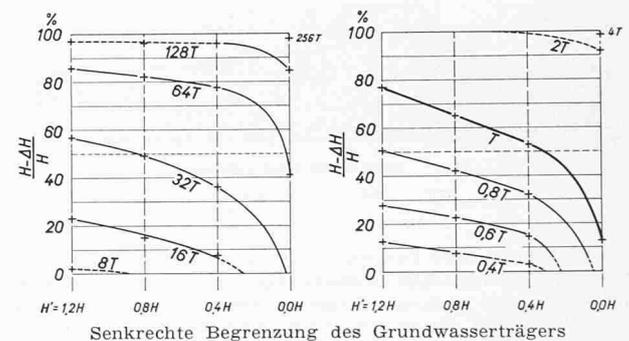
Bild 7. Darstellung der Grundwasserspiegellage (Sickerlinie) für die  $k/(n_s \cdot v)$ -Werte 0,70 und 100,0 in den Messquerschnitten: «Böschung» und  $8,7 H$  (= Modellbegrenzung) für die vier untersuchten Grundwasserträgertiefen:  $H' = 0,0/0,4/0,8$  und  $1,2 H$ .
