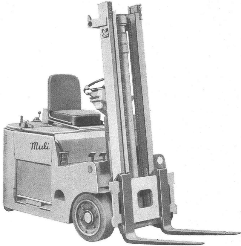
MULI-Gabelstapler in 3- und 4-Radkonstruktion
