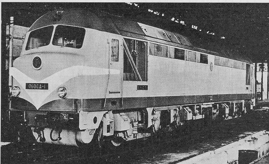
Bild 17. Lokomotive von 2400 PS mit zwei Freikolben-Gruppen
