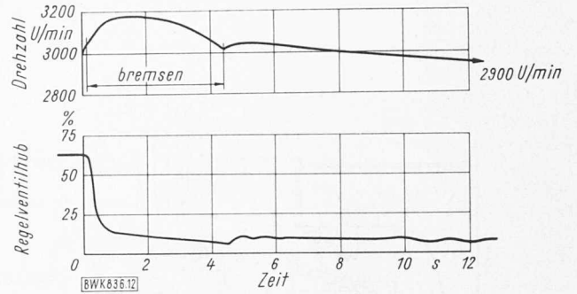
Bild 5. Drehzahl der Nutzleistungsturbine und Regelventilhub bei plötzlichem Abwurf einer Belastung von 39 MW
