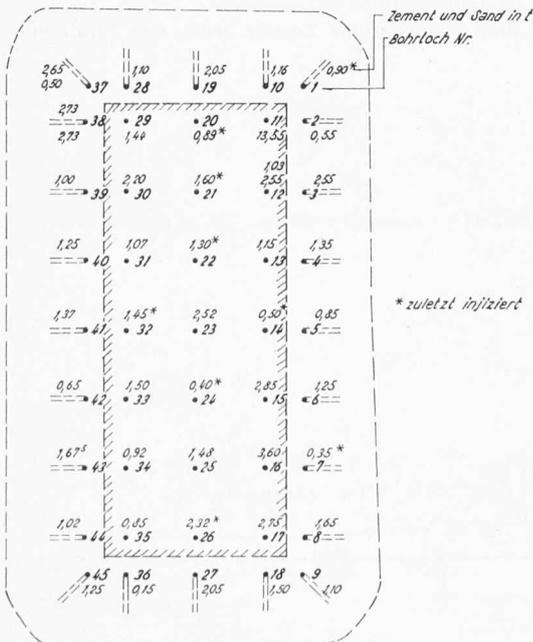
Bild 6. Widerlager Ems: Anordnung der Bohrlöcher, Aufnahme und Verteilung des Injektionsgutes. Masstab 1:250.
