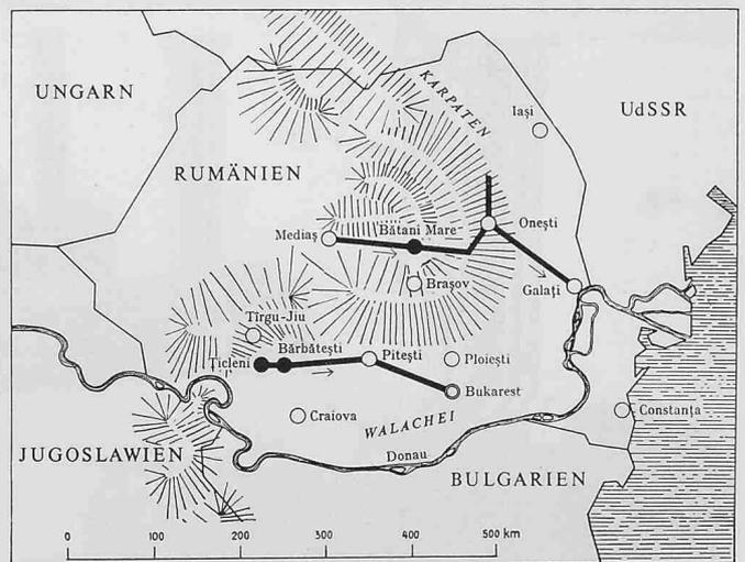
Bild 1. Lageskizze der rumänischen Erdgasleitungen und Kompressorstationen, Masstab 1:1 000 000
