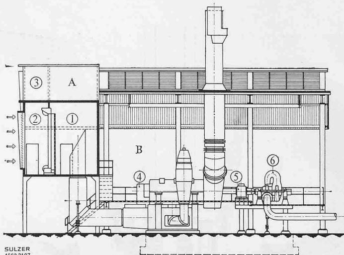
Bild 6. Pipeline-Pumpstation mit Gasturbinenantrieb von 3000 kW
