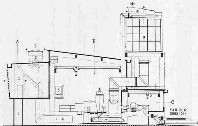
Bild 5. Pipeline-Kompressorstation mit Gasturbinenantrieb von 3000 kW
