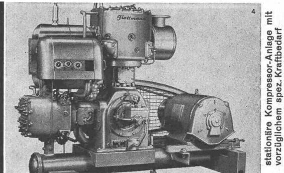
stationäre Kompressor-Anlage mit vorzüglichem spez. Kraftbedarf
