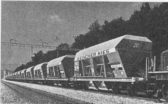
Bild 1. Kieszug der SBB, bestehend aus speziellem Wagenmaterial der Weiacher-Kies AG. Jeder Wagen wiegt leer 20 t und fasst 38,5 m 3 oder 60 t Kies.
