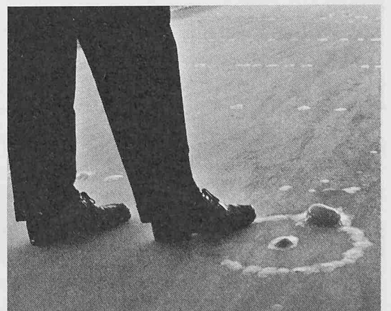
Bild 6. Die Wirkung eines Tiefstrahlers nach einer feuchten Nacht im November 1963. Die Lampen-Unterkante befand sich etwa 2,3 m über der Piste. Im Hintergrund Tropfenspuren der Balken, Balkenunterkante etwa 2,5 m über der Piste
