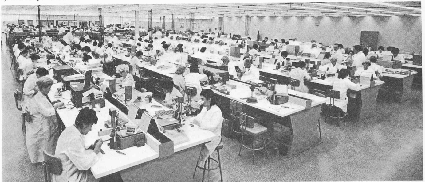
Bild 12. Bourns Inc., Riverside, Kalifornien. Arbeitsraum für die Herstellung von elektronischen Geräten. An der Decke sind die überall anzutreffenden Sprinkleranlagen sichtbar
