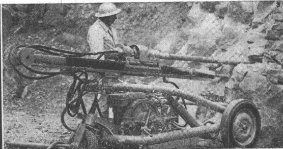
Grosslochbohrwagen mit hydraulischem Antrieb für Lochhämmer
