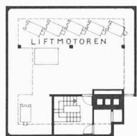
Bild 13. 15. Obergeschoss 1:500 mit Liftmotoren (vgl. auch Bild 22)
