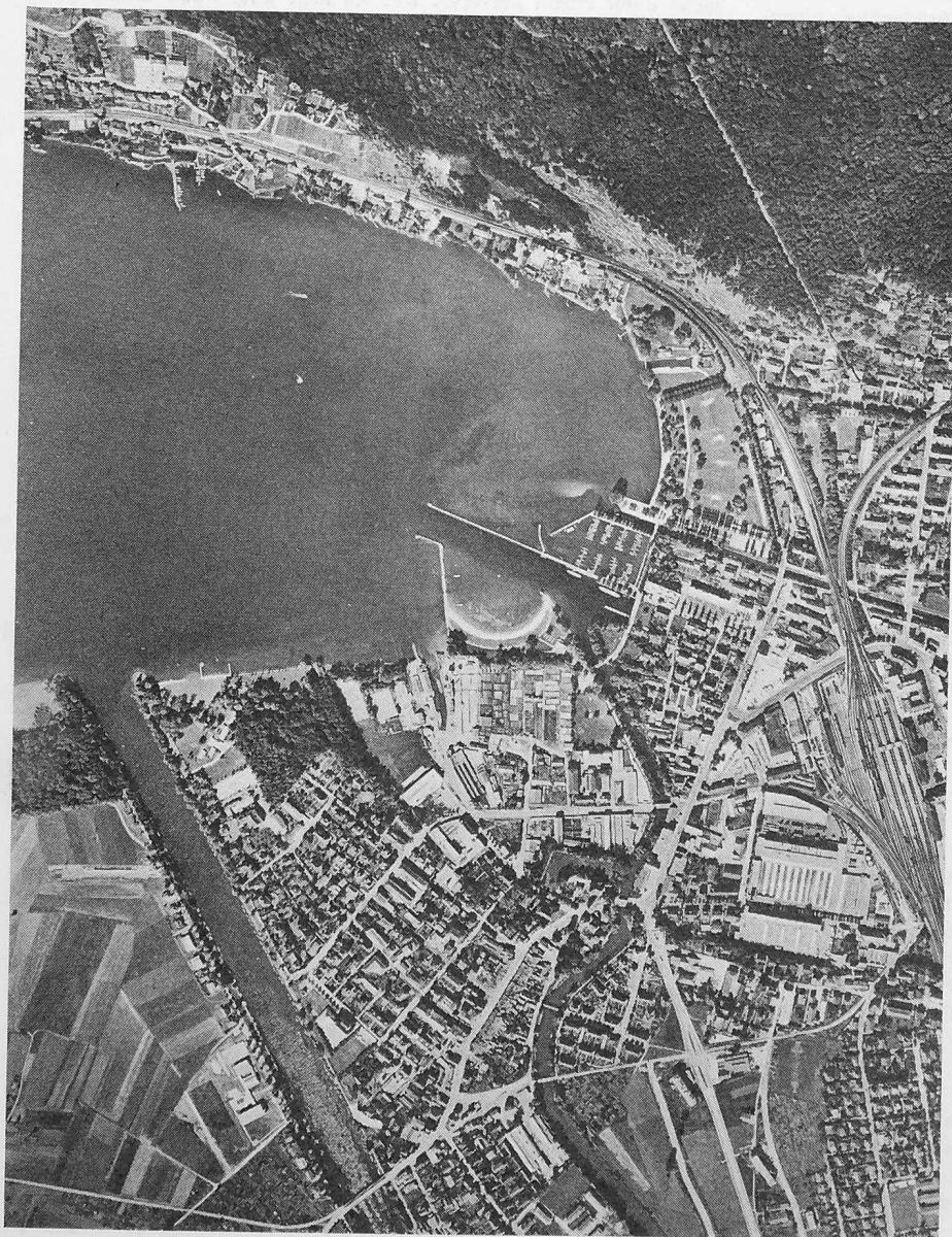
Bild 1. Flugaufnahme des bestehenden Zustandes. Form der Bucht, Kleinboothafen und linke Dampfschiffmole verhindern Durchspülung der Bucht
