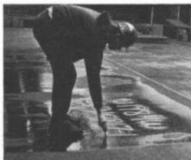
Bezeichnung nasser Stahlplatten mit MARKAL Type «B»-Stiften.
