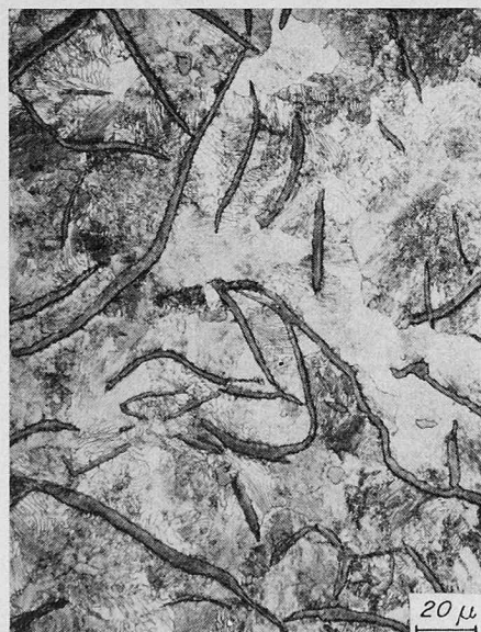
Bild 3. Gusseisen mit Lamellengraphit mit perlitischer Grundmasse (geätzt)
