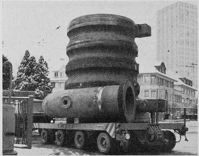
Fig. 6. Transport du corps de pompe entre deux ateliers d'usinage, à Winterthur. Poids de la pièce terminée: 80 t (Photo Sulzer Frères)
