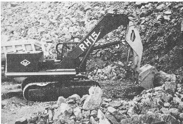
Bild 3. Ansicht des Haufwerks beim analysierten Einsatz (für einen Bagger von 1,8 m 3 als «schwer» zu bezeichnen)
