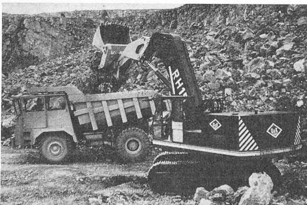
Bild 12. Entladen der Schaufel in Fahrzeuge
