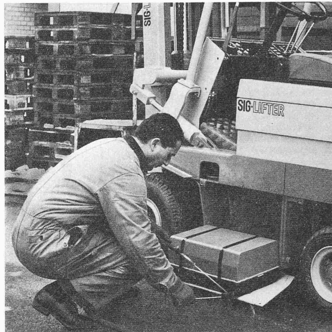
Bild 11. Die im SIG-Lifter verwendete Impulssteuerung ist nicht nur gegen Eindringen von Schmutz und Wasser vollständig geschützt. Wenn sie stark verschmutzt ist kann sie auch leicht gereinigt werden
