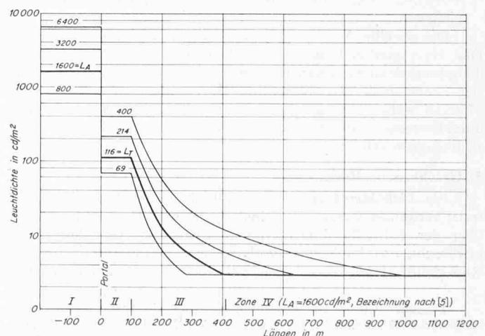
Bild 1. Leuchtdichte-Verlauf für Höchstgeschwindigkeit 80 km/h. Adaptationspunkt rund 25 m vor dem Portal. Anhaltstrecke nach SNV 40 130 a.  $L_A$  = Aussenleuchtdichte,  $L_T$  = Leuchtdichte im Tunnel
